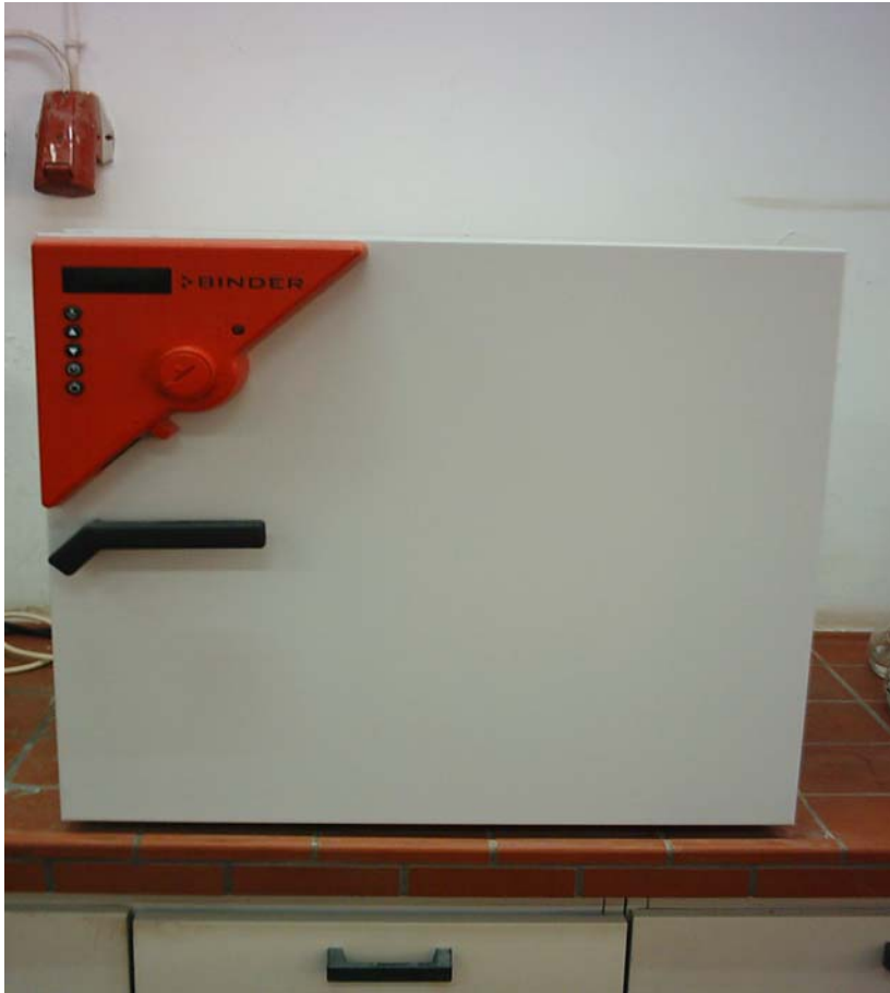
شكل (٢) فرن كهربائي لتقدير الرطوبة في الأغذية.
