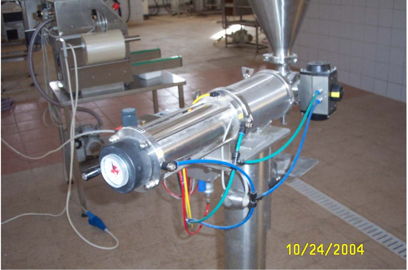
شكل (٣) هندل التحكم في كمية المادة الغذائية
