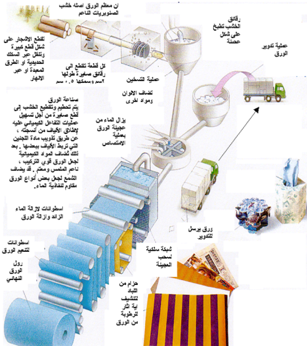
شكل (١): رسم تخطيطي يوضح مراحل تصنيع الورق
