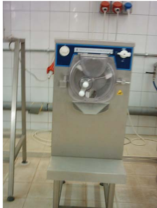
شكل (١٨) صورة لجهاز تصنيع الآيس كريم
