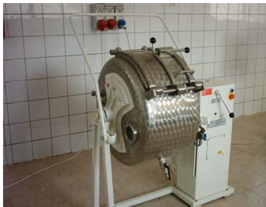
شكل (١١) خضاض يستخدم في مصانع الألبان.
