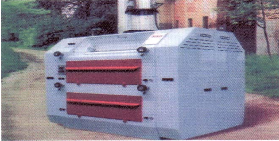
شكل (٢٤) جهاز طحن بالسلندرات.
