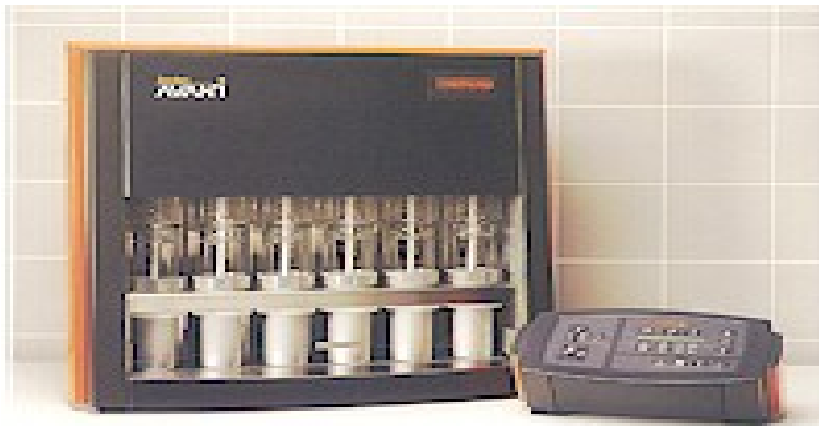
شكل (٢٢) جهاز سوكسنت لتقدير الدهن في الأغذية.
