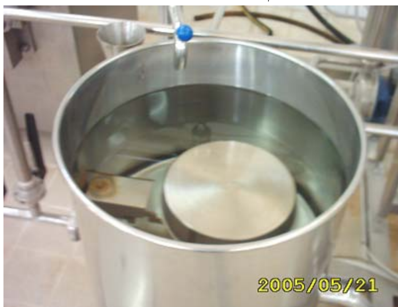
شكل ٢,٥ التحكم في مستوى المادة في الصهريج باستخدام العوامة
