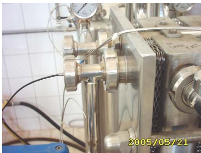
شكل ٤,٥ المزدوجة الحرارية لقياس درجة حرارة الحليب الخارج من قسم التسخين في المبادل الحراري
