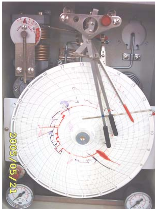
شكل ٦,٥ ضبط مفاتيح التحكم في عنصر التحكم الموجود في جهاز البسترة.
