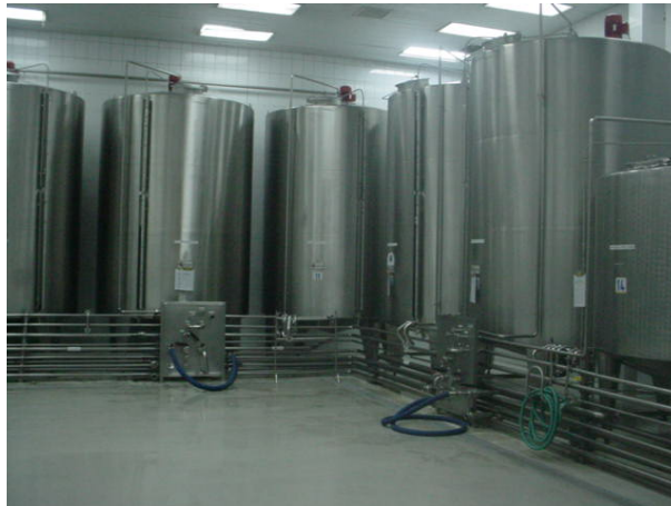
شكل (٥٣) أجهزة خلط غاز ثاني أكسيد الكربون والماء
