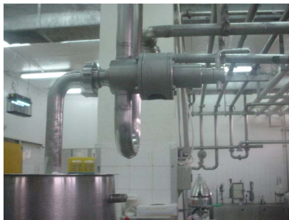
شكل (٦٦) مضخات لدفع وسحب الحليب
