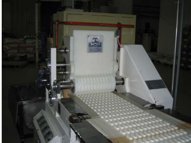
شكل (٧٢) آلة التشكيل في مصنع الحلويات
